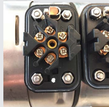
Toma de cable con conexiones de tornillo
