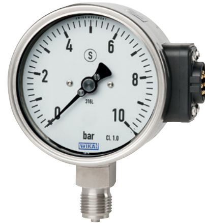
Manometro a molla Bourdon per il collegamento con l'unità radio WIKA, modello PGU23.100
