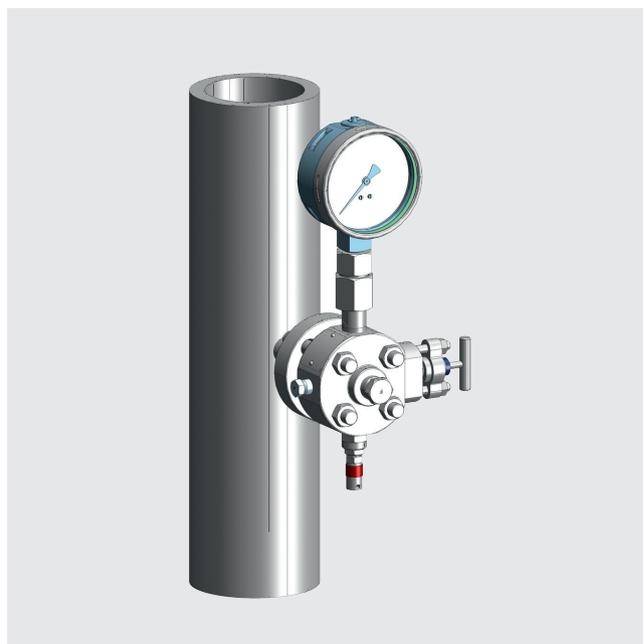
Монофланцы в инструментальной версии, как показано, монтируются после основного отсечного устройства. Монофланцы в технологической версии имеют крышку OS&Y для обеспечения отсечки со стороны процесса. Конструкция крышки OS&Y с большим проходным сечением предотвращает закупорку скапливающимися частицами. При использовании монофланцев в инструментальной версии можно сэкономить на традиционных запорных вентилях.
