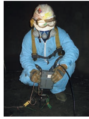
Membre de l'équipe service WIKA/Gayesco sur un étalonnage "in situ" dans un réacteur
